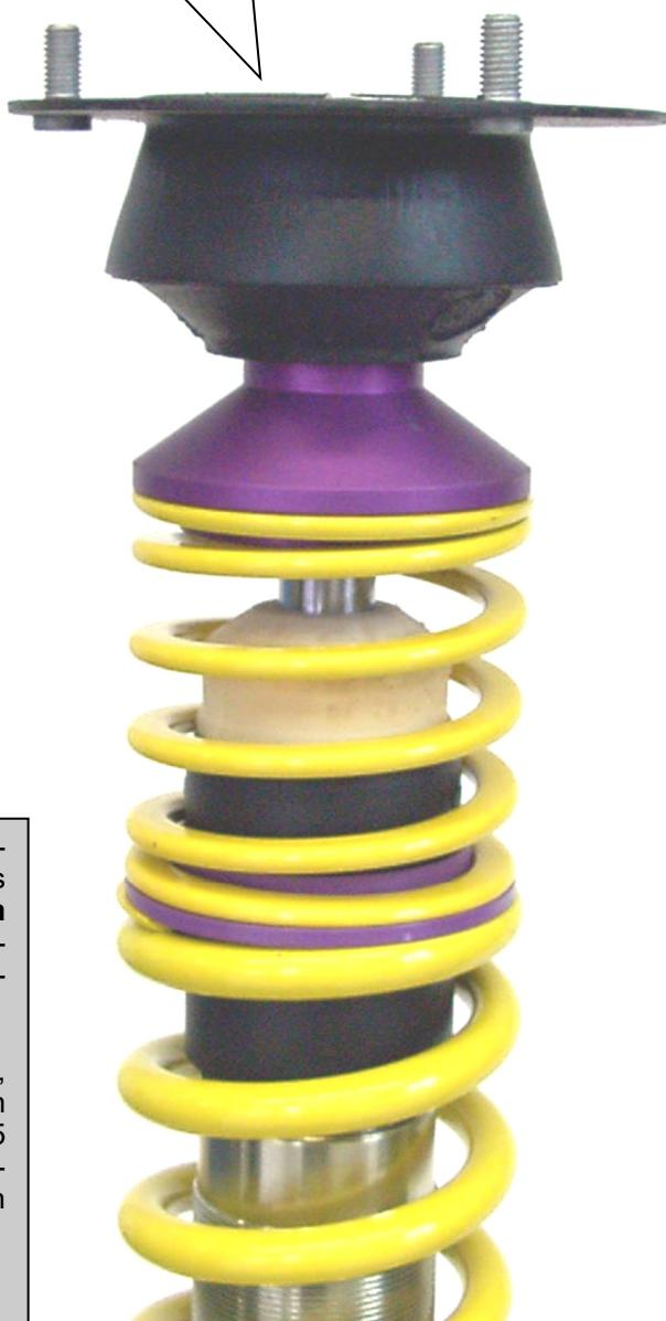
Nach erfolgtem Einbau des Fahrwerkes ist die Freigängigkeit der Bereifung zum VA-Federbein zu überprüfen. Das Mindestabstandsmaß an der engsten Stelle darf **5 mm** nicht unterschreiten und ist gegebenenfalls mittels handelsüblicher, TÜV geprüfter Distanzscheiben wieder herzustellen.
