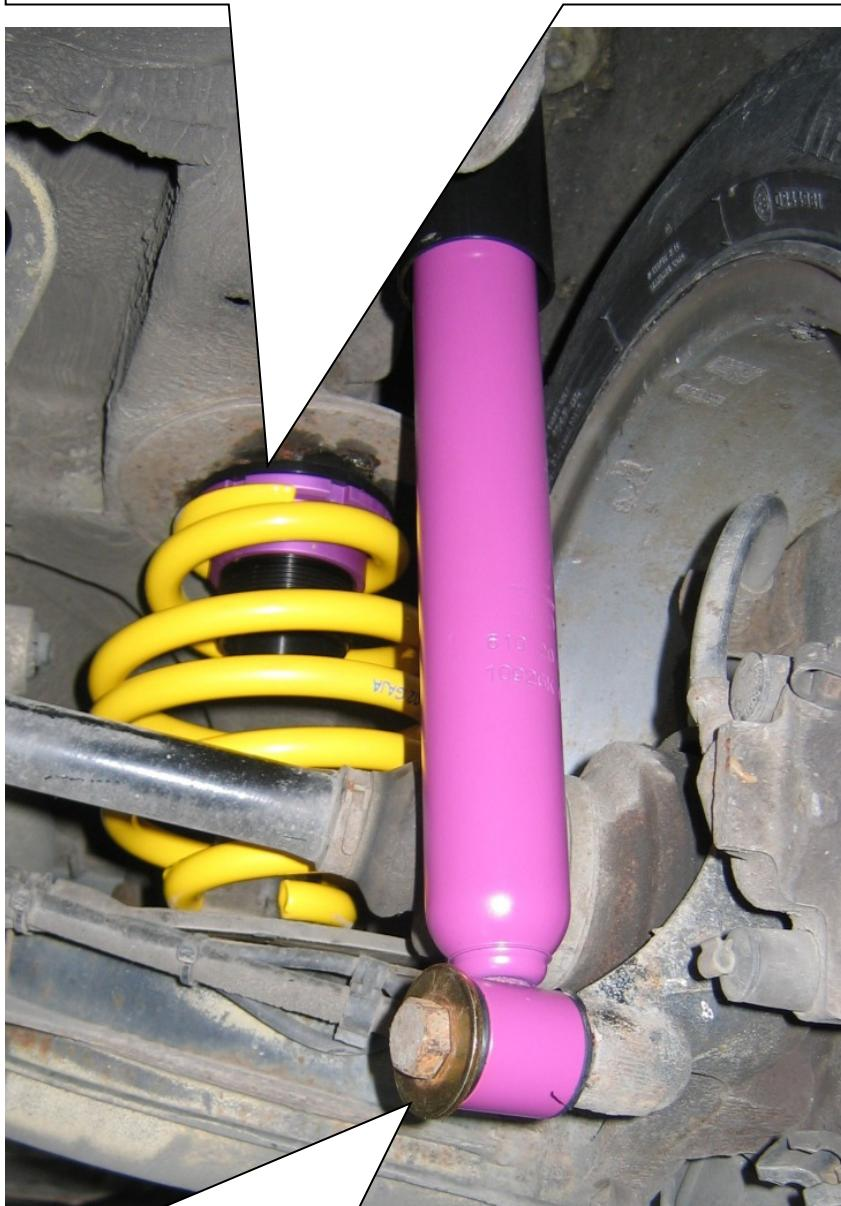
Bei der unteren Dämpferbefestigung muss die mitgelieferte Beilagscheibe eingebaut werden. Dabei darauf achten, dass die Scheibe in Richtung Fahrzeugmitte montiert wird (siehe Bild).
