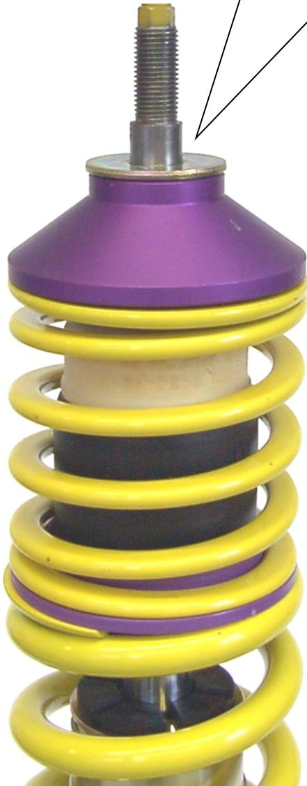
Original Stützlager aufstecken und mit der mitgelieferten Stoppmutter verschrauben. Das Anzugsdrehmoment der Kolbenstangenbefestigung beträgt 35 Nm. Die Montagehinweise zum Einbau des Federbeines in das Fahrzeug, sowie die Anzugsdrehmomente der Federbeinbefestigung, entnehmen Sie bitte den Unterlagen des Fahrzeugherstellers.
